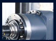
COOLANT SPRAY GUN ON THE SPINDLE HEAD
